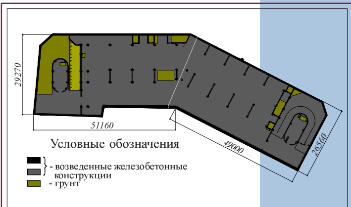
Рис. 7. Многофункциональный комплекс «Арбат-Центр» в Москве. План-схема несущих конструкций -2-го этажа подземной автостоянки и рамп на -3-м этаже (пандус рампы на западной половине автостоянки условно не показан) во время экскавации грунта в котловане 4-го яруса под их защитой.
