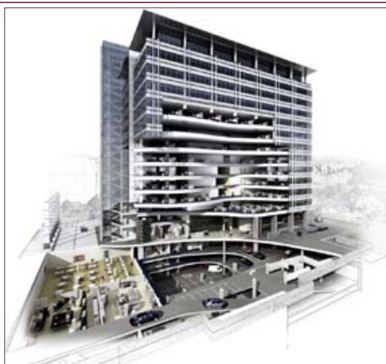
Рис. 1. Общая схема здания с подземным трехуровневым пространством (стадия ТЭО).
