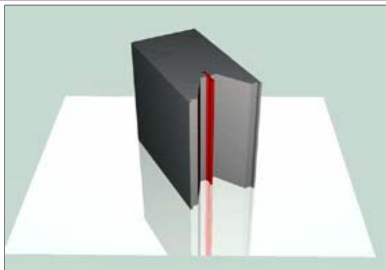
**Рис. 1.** Фрагмент опережающей панели траншевой стены с гидропрокладкой «Waterstop» после извлечения ограничителя «Stopsol».
