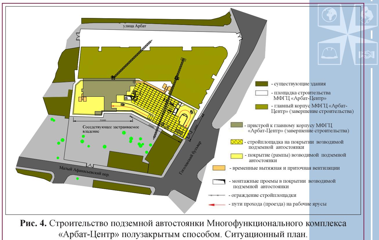
**Рис. 4.** Строительство подземной автостоянки Многофункционального комплекса «Арбат-Центр» полузакрытым способом. Ситуационный план.
