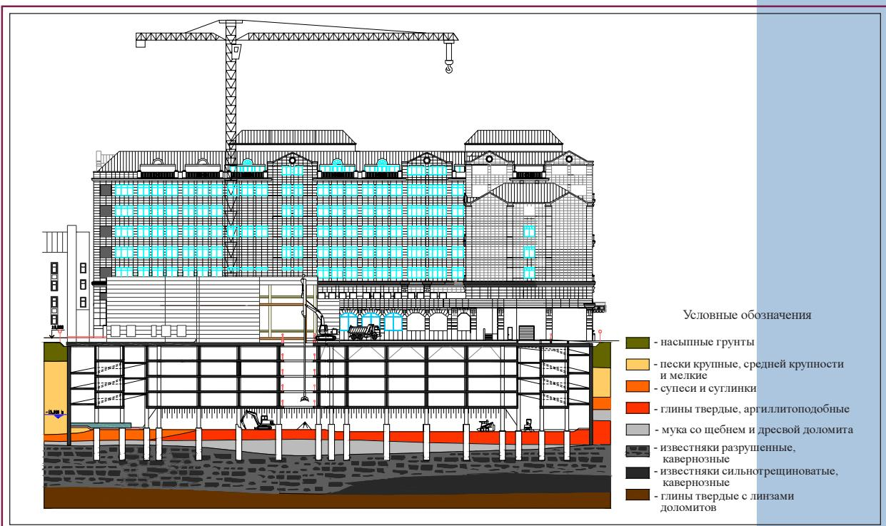
**Рис. 3.** Строительство подземной автостоянки Многофункционального комплекса «Арбат-Центр» полузакрытым способом. Продольный разрез.
