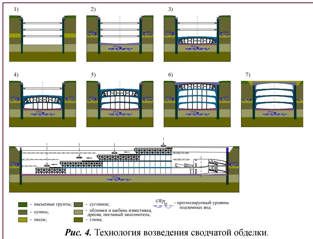
**Рис. 4.** Технология возведения сводчатой обделки.
