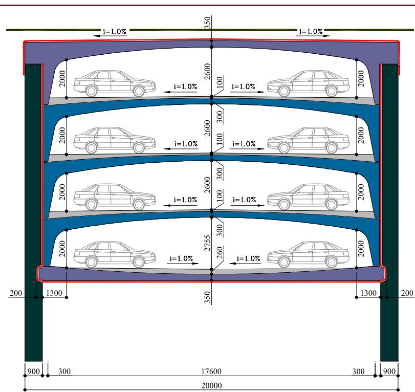
*Рис. 3. Поперечное сечение сводчатой обделки*
